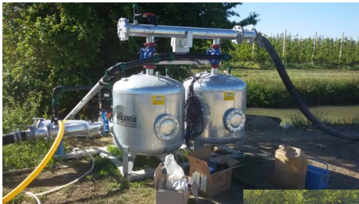
Gruppo di filtraggio a quarzite + centralina
